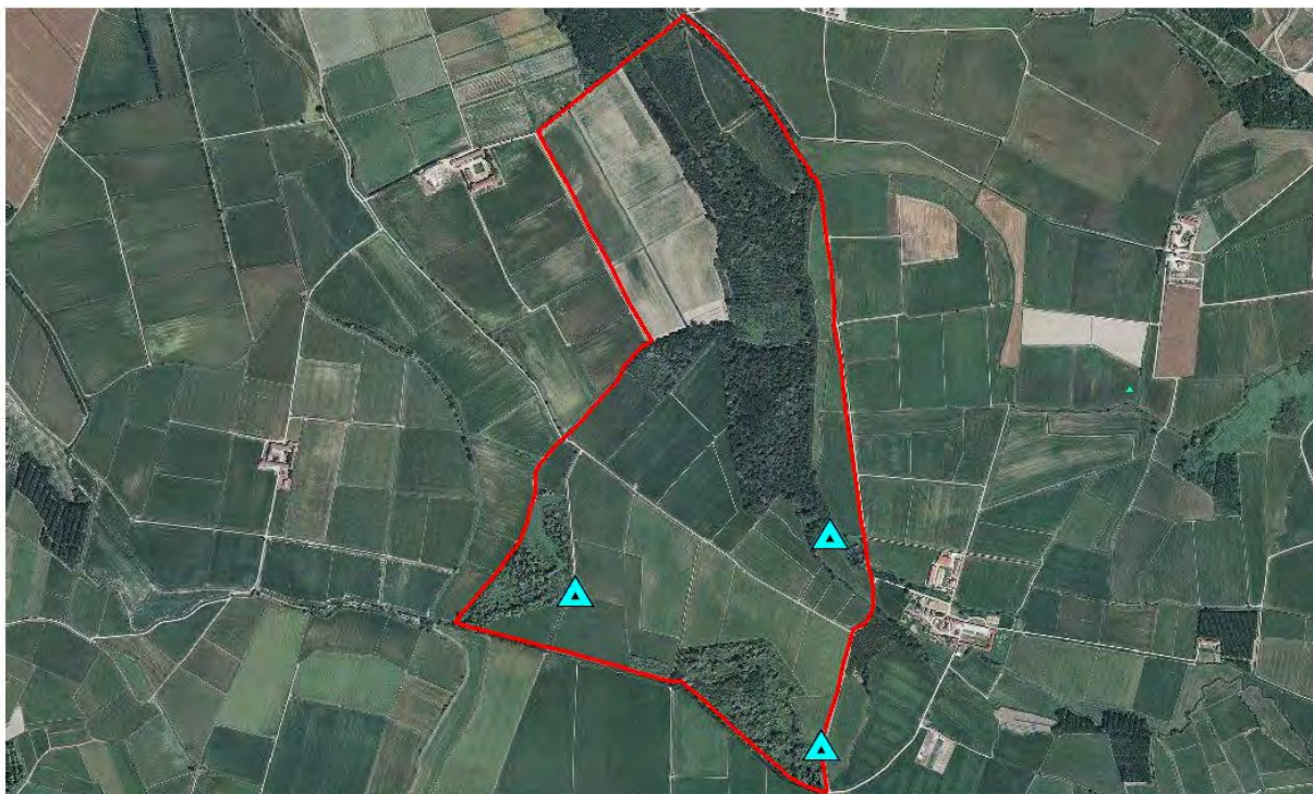
Figura 2.3 – Posizionamento dei piezometri all'interno del SIC Abbazia di Acqualunga.
